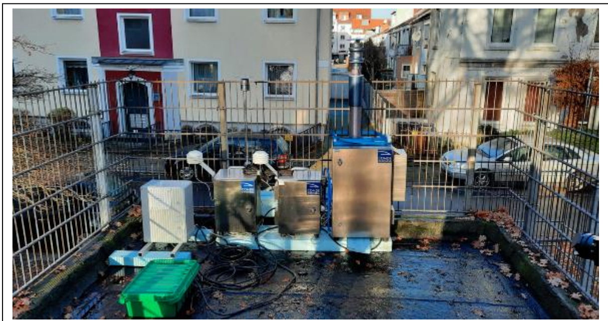
Foto: Sondermessprogramm Kaminöfen - Messgeräteanordnung
